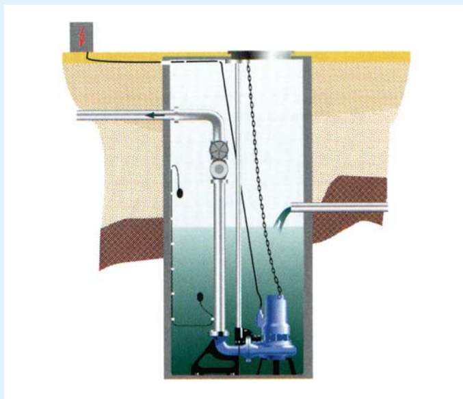
Pumpwerk der Abwassertauchpumpe ORCUT TES Bild 1
